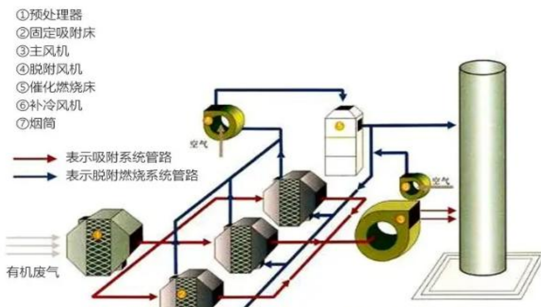
图 4-3 吸附浓缩+催化燃烧装置示意图
