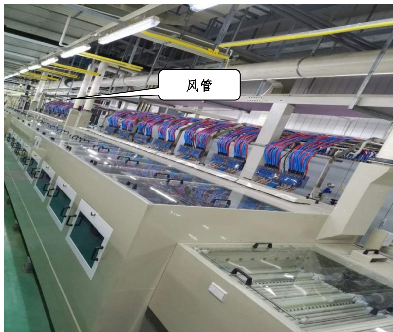
图 4-2 连续镀生产线废气收集示意图
